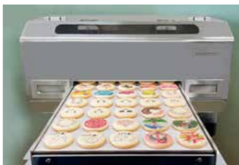
2023年にM&Aしたマスターマインド社の主力製品のひとつ、フードプリンター。非接触・非加熱で色彩も豊か。一度にさまざまなデータの印刷が可能
